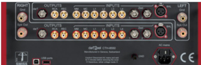
Kryptisch? „darT“ = Spezial-Eingang, „Zeel“ = Spezial-Ausgang, USB = non-audio
